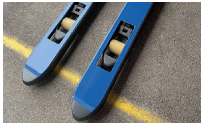
Abb.: Lebensmittelgerechte Gabelzinkenbeschichtung
