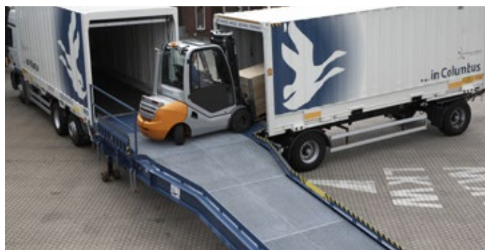
Abb.: Verladeplattform mit Überladebrücke zur Flächenerweiterung zwischen Fahrzeug und Rampe.
