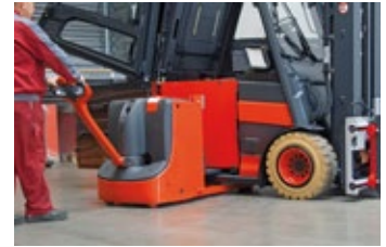
Schritt 2: Batterie mit dem Hubwagen ROTABATT 80 V herausfahren
