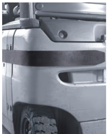
Abb.: Auch als Rammschutz für das Stapler-Chassis verwendbar
