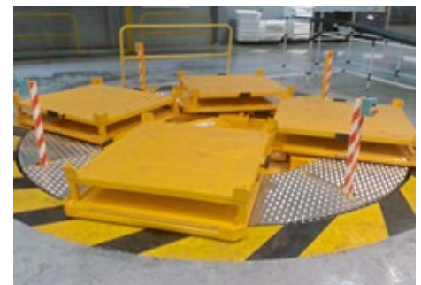
Anwendungsbeispiel: 4 x 90°-Luftkissen-Drehplattform mit Aufnahmen für Ladungsträger
