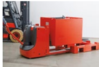
Schritt 3: Entnommene Batterie auf der Plattform absetzen
