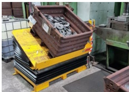
Abb.: Pneumatisches Hub-Neigegerät als Stand-alone-Gerät oder zur Montage auf Drehplattformen
