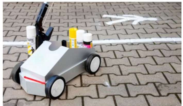
Richtung der Markierung je nach Bedarf: Der Sidestriper (links) kommt für randnahe Markierungen zum Einsatz.
