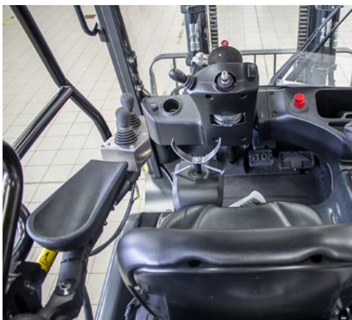
Das neue Cockpit von Torsten Krohns Gabelstapler hat kein Lenkrad mehr. Dafür einen Joystick, den er mit dem linken Oberschenkel bedient. Auch die Staplerbedienung wurde auf die linke Seite verlegt.
