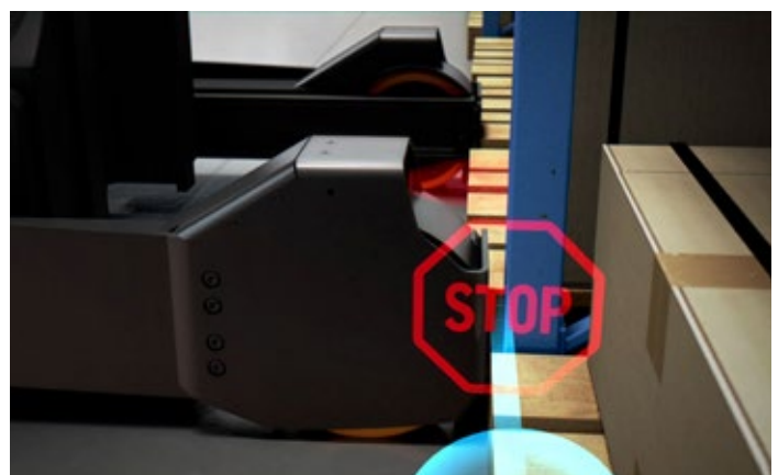
Abb.: Der Regalanfahrschutz Rack Protection Sensor (RPS) von Linde erkennt durch zwei Lichtsensoren automatisch Hindernisse beim Manövrieren am Regal und bremst den Stapler dynamisch ab.
