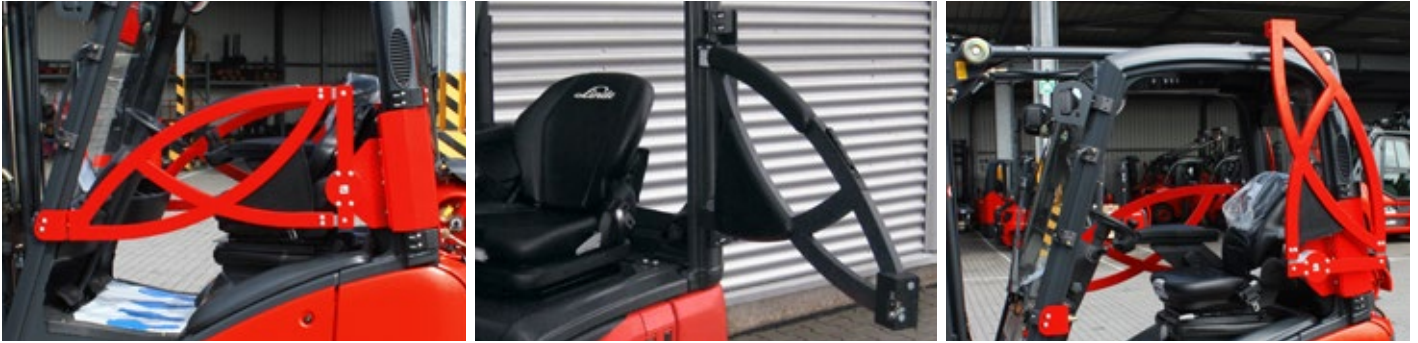
Abb.: Beim SRS (links) öffnen und schließen beide Bügel wie eine Tür, beim SRS CONCEPT (rechts) schwenkt der linke Bügel beim Öffnen nach oben
